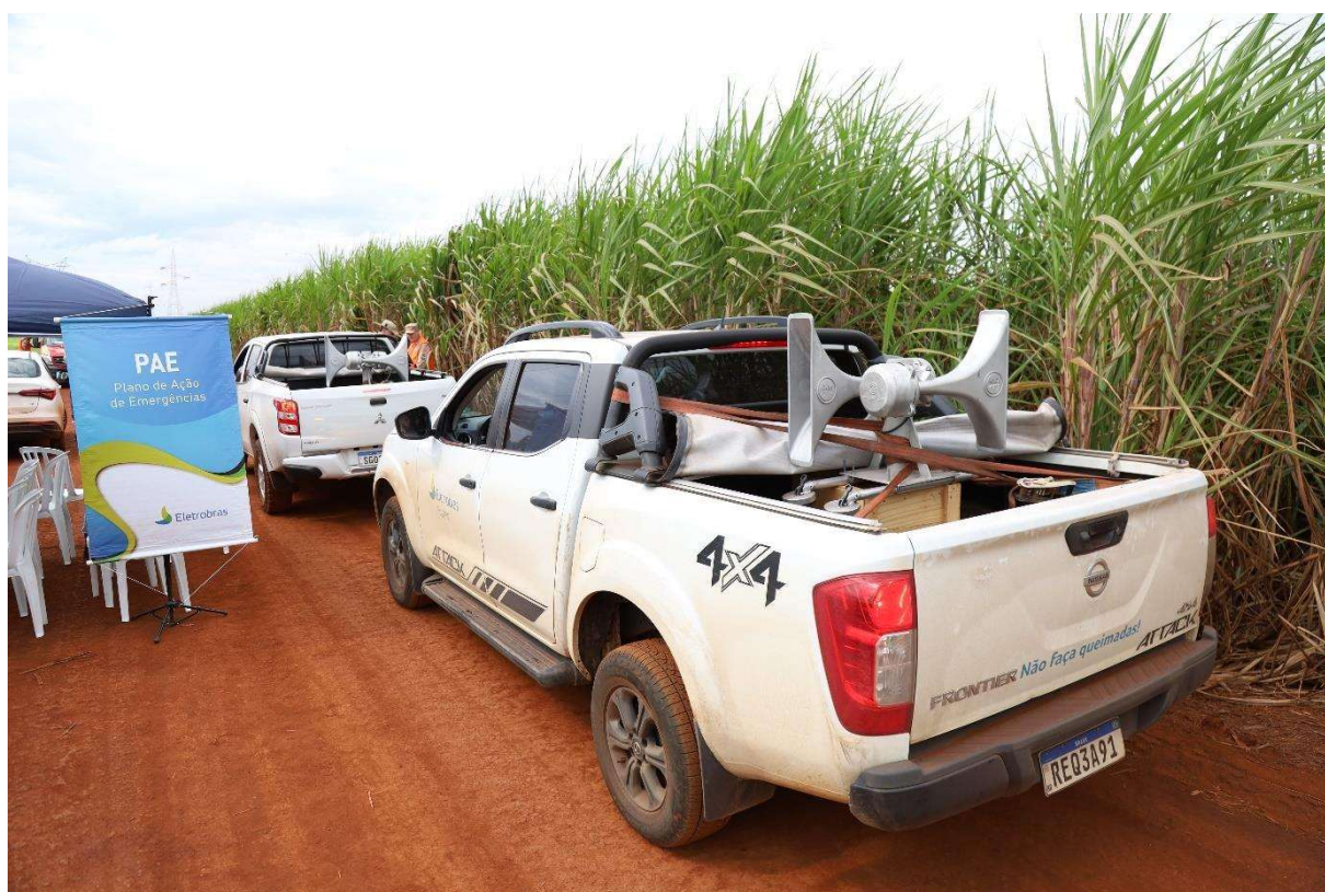
Figura 6 – Modelo de Sirenes Móveis instaladas em caminhonetes.
